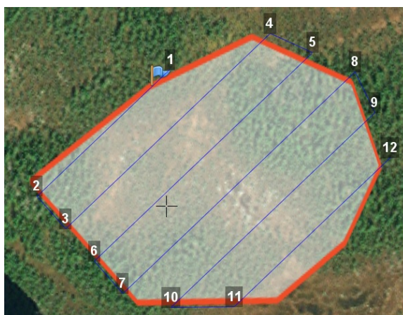
Рис. 50: Точка входа в полигон
