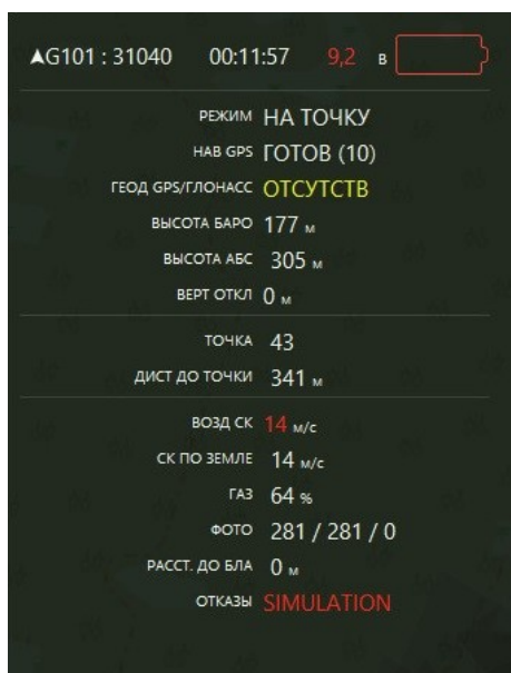
Рис. 112: Снижение скорости в панели телеметрии с разряженной батареей
