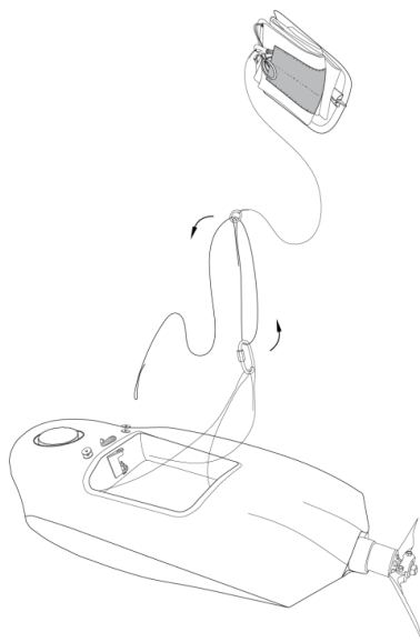
Продевание конца короткого фала через кольцо системы отцепа
