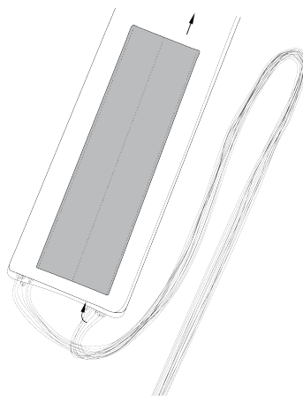
Укладка строп в карман
